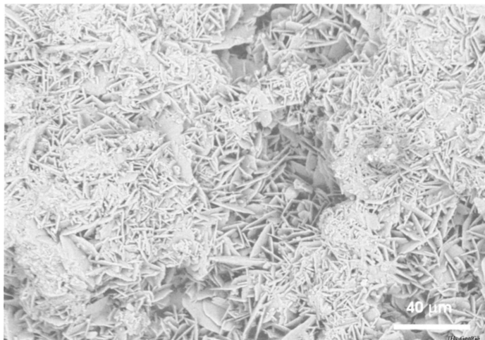
8. ábra. Mikrométeres nagyságrendű gipsz rozettákból álló, fekete, mállási kéreg pásztazó elektronmikroszkópos felvétele (Várkert bazár)
