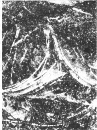
12. ábra Filamentumos, peloidos wackestone, a matrix kezdődő dolomitizációjával. E típusú mikrofácies. 27. sz. réteg. N=25x
