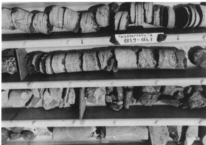
3. ábra. 183,9–184,1 m, a laminit brecciasán feltöredezett teteje és a radioláriás szakasszal való érintkezése (a ládaperem beosztása 10 cm-es)
