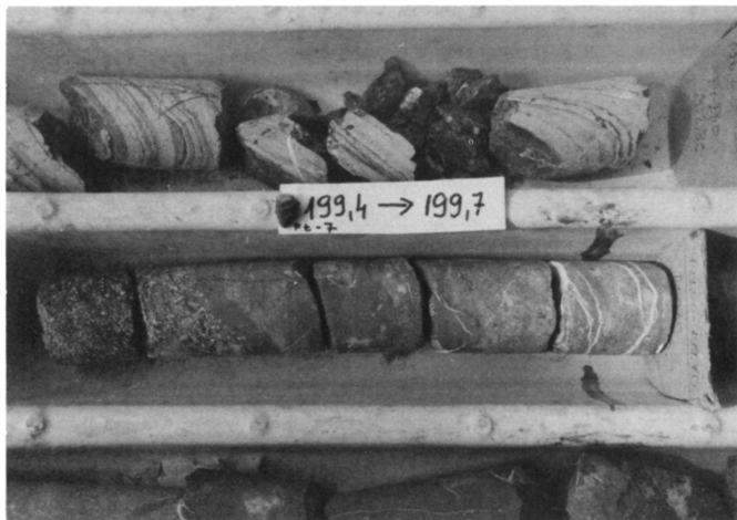
4. ábra. 199,4–199,7 m, átülepített vulkáni finomtörmelék az ignimbrites szakasz fölött (a ládaperem beosztása 10 cm-es)
