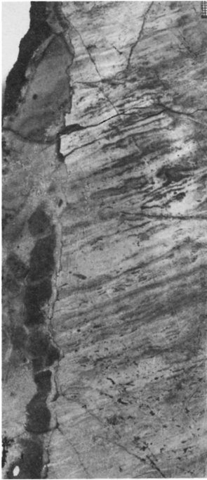
8. ábra. Részben homogenizálódott laminit elmosódó sávzottsággal. A mag bal oldalán repedéskitöltés 55,8–56,0 m
