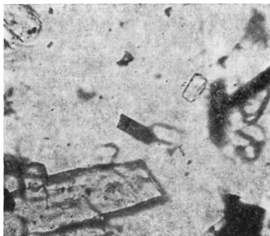
2. ábra. Mullit kristály négyzet-alakú (pszeudo-tetragonális) metszete (középen). Nagyítás: 600 \times Fig. 2. Square-shaped (pseudotetragonic) cross-section of mullite crystal (centre). Magnification: 600 \times
