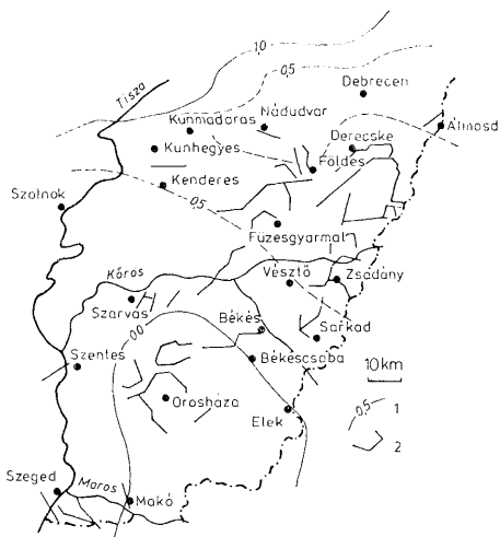
7. ábra. A kőolajkutatás során meghatározott délkelet-magyarországi törésvonalak (ZsÍros T. után). J e l m a g y a r á z a t: 1. Felemelkedés 0,5 mm/év, 2. Törésvonal
