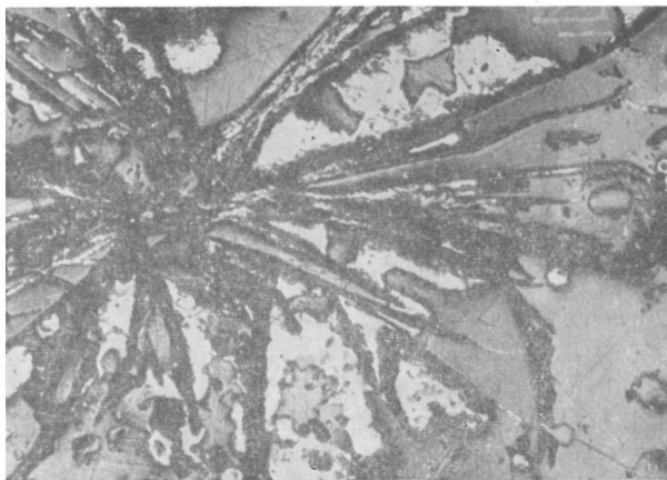
7. ábra. A sugárszerűen elágazó molibdenitpikkelyek közötti teret pirit tölti ki. // N, 220× Fig. 7. The space between radiating molybdenite flakes is filled with pyrite
