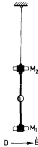
3. ábra. Az asztatikus magnetométer lengőjének felépítése Jel magyarázat: M 1 és M 2 asztatikus mágnespár
