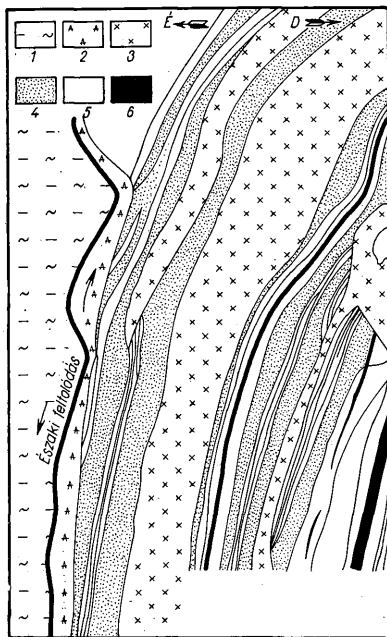
7. ábra. Északi feltolódás az Anna-bányauzem területén. Magyarázat: 1. Fedőmarga, 2. Andezit, 3. Trachidolerit, 4. Pszammit, 5. Pelit, 6. Feketekőszén
