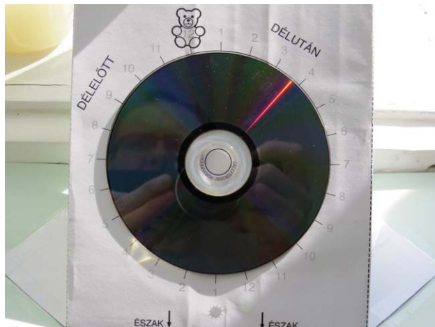
4. ábra. Nyáron használható ekvatoriális CD-napóra.
