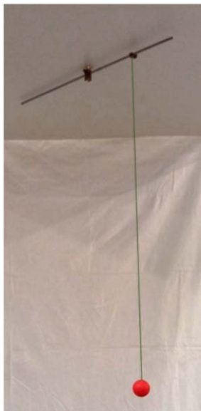
4. ábra. A késlekedő inga kísérleti összeállítása.
