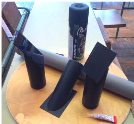
1. ábra. A Brewster-periszkóp alkotó elemei: PVC-cső, üveglapok, pillanatragasztó, festék (balra) és a deszkalapok (jobbra).
