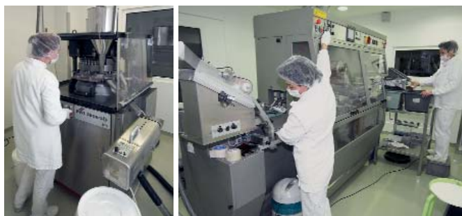
Üzemi gyártás a szilárd gyógyszerforma (OSD) üzemben; tablettázás és bliszterezés
