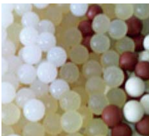
2. ábra. Makrokapszulázott fázisváltó anyagok (PCM Products Ltd. [5])
