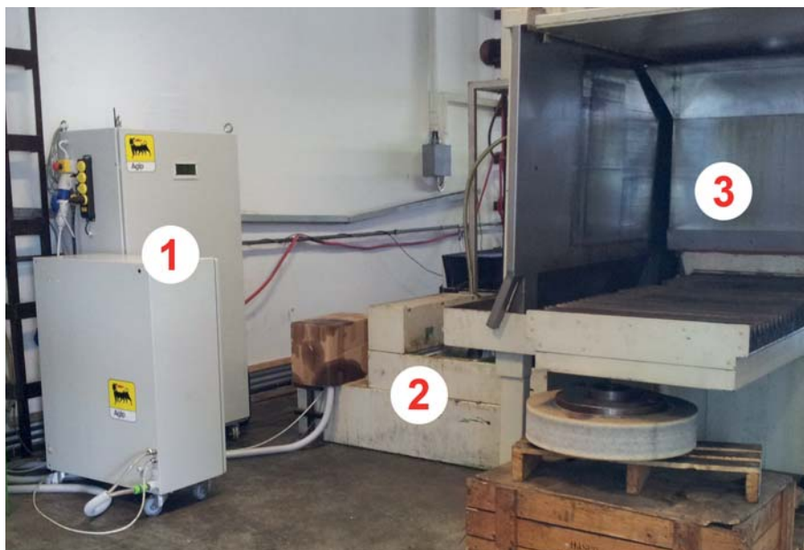
3. ábra. Az emulziókezelő készülék egy CNC köszörűgép emulziótartálya mellé telepítve: 1 – emulziókezelő készülék; 2 – emulziótartály; 3 – CNC köszörűgép
