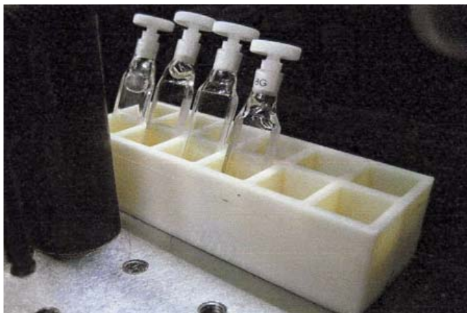
5. ábra. 3D nyomtatással készült: elektroforézishez használt műanyag fésű [21], Büchner-tölcsér [23], küvetatartó állvány [22]
