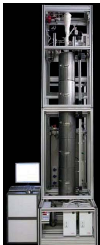
4. ábra. A MOL DS Fejlesztés MicroDowner reaktora FCC-katalizátorok vizsgálatához
