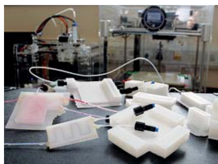
6. ábra. 3D nyomtatott mikrofluidikai reakcióedények [28]
