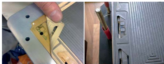
9. ábra. A bipolaris lap a gáz- és vízvezető csatornákkal. A korrózió ellenőrzése 1 év működés után
