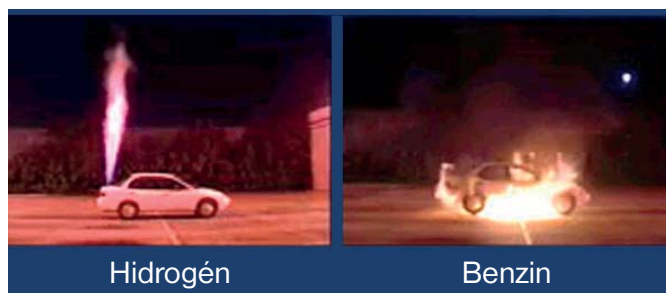
12. ábra. Egy hidrogénnel, illetve egy benzinnel hajtott gépkocsi égési tesztje
