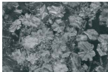
4. ábra. A kikristályosodott azo-bisz-izobutíro-nitril
