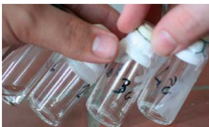
6. ábra. A 80 órás reakcióidő lejártá után a többi minta is begélesedett, kivéve természetesen a homopolimert
