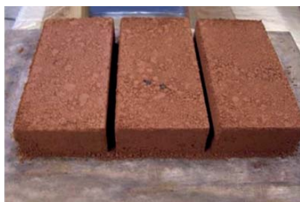
1. ábra. Vörösiszadból készített falazóelem
