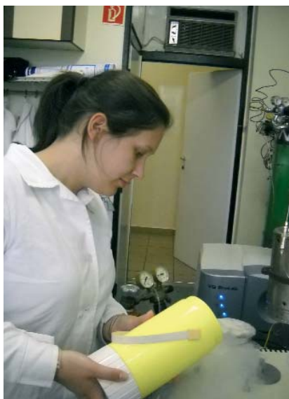
Folyékony nitrogénnel hűtjük a rendszert
