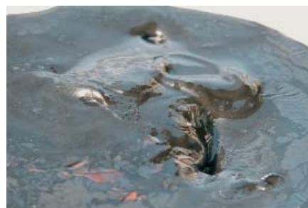
Olajos üledék az Alg-915 vízbesajtoló kútból
