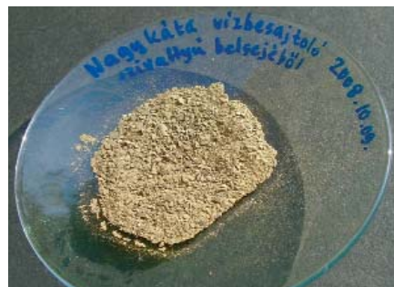
CaCO 3 vízkő besajtoló szivattyúból (Nagykátai)
