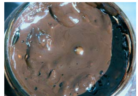
Olajos üledék az Alg-318 vízbesajtoló kútból
