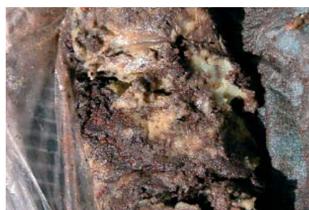
Menetzsíros lerakódás gázkútból
