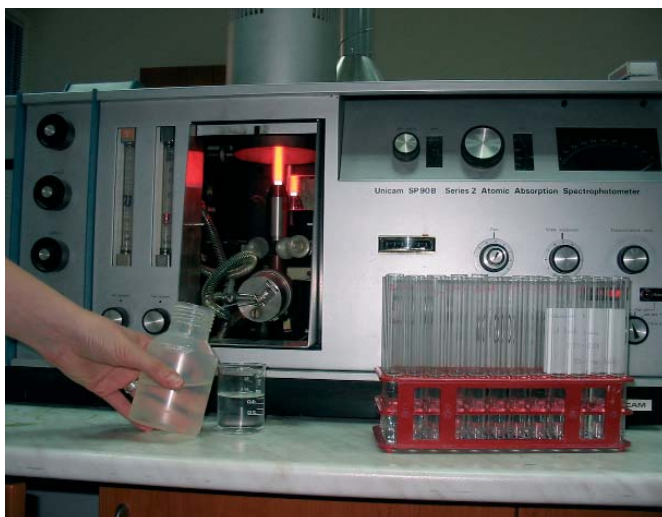
5. ábra. Emissziós lángfotométer. A fotométer segítségével a növények és talajok káliumtartalma határozható meg
