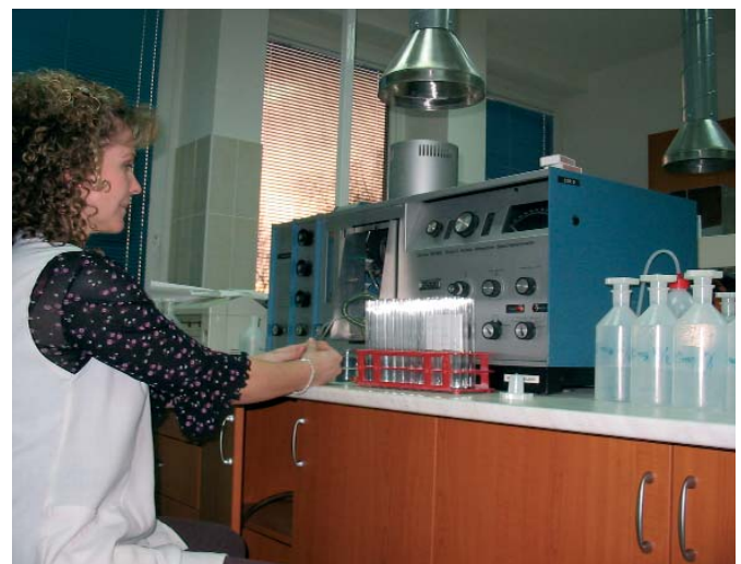
6. ábra. Atomabszorpciós spektrofotométer. Segítségével a növények és talajok kalcium-, magnézium-, vas-, cink-, réz- stb. tartalma mérhető
