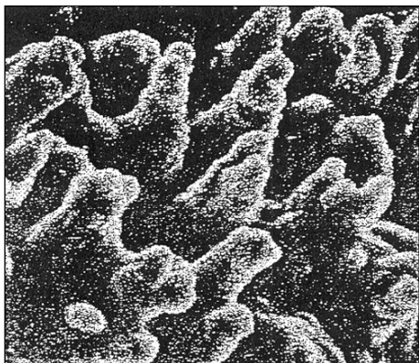
4. ábra. Szívószelep-lerakódás elektronmikroszkópos felvétele (nagyítás: 3 000-szeres)
