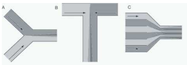
5. Ábra. Áramlási profilok különböző geometriájú csőszakaszoknál.
