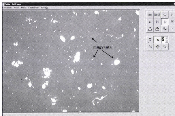
2. ábra. Adalék elkülönítése aszfaltban kétszintre vágással
