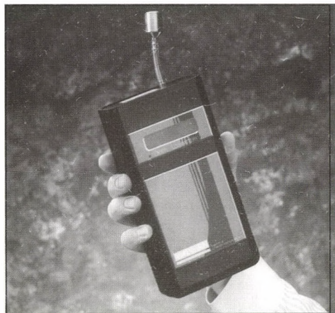
3. ábra. A HHC 3001/5001 típusú lézeres levegő portartalom mérő és részecske számláló az angol Malvern cégtől
