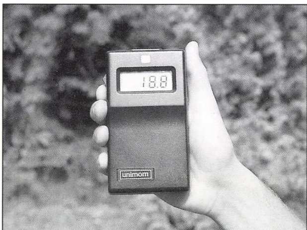
1. ábra. A MOM Globios UNIMOM típusú kézi lézer-teljesítmény mérője
