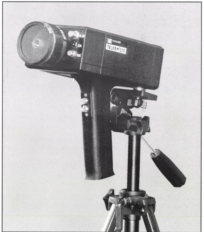
4. ábra. A Hőmezővászárhelyi Állami Tangazdaság TELERM-220 típusú infravörös hőmérsékletmérője
