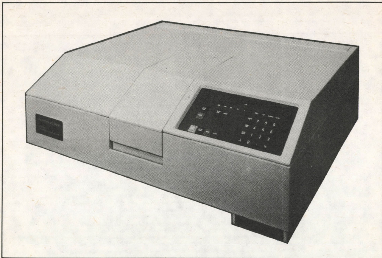
13. ábra. Perkin-Elmer gym. Lambda-3 típ. UV-látható tartományú spektrofotométer
