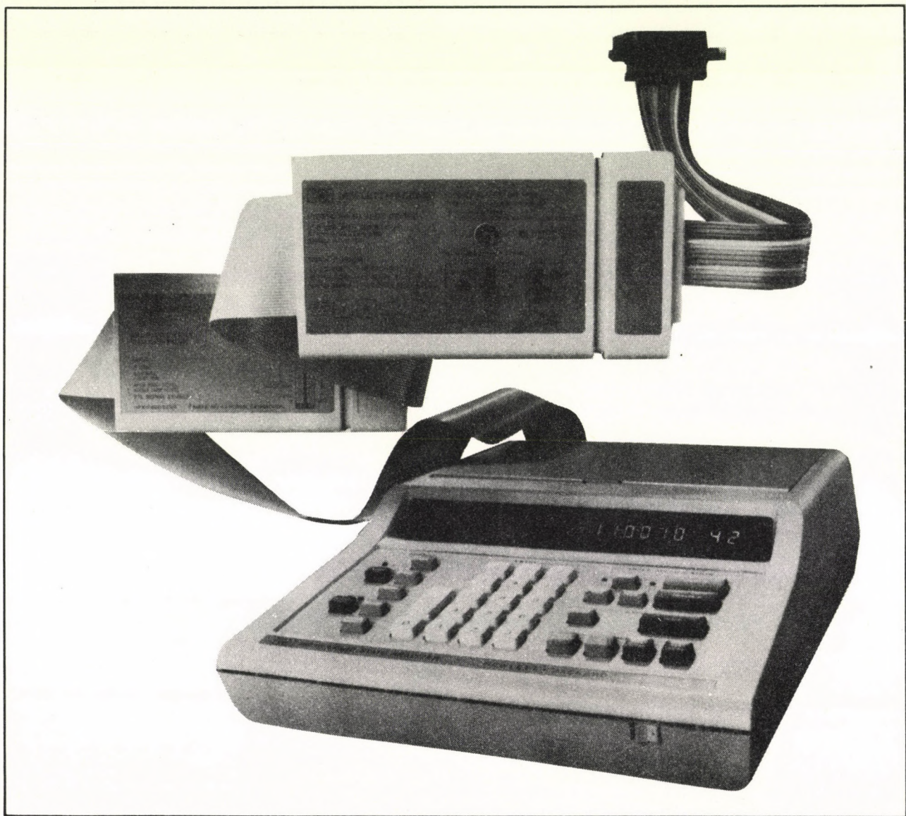
9. ábra. Hewlett-Packard gyártmányú logikai analízátor IEC adapterrel
