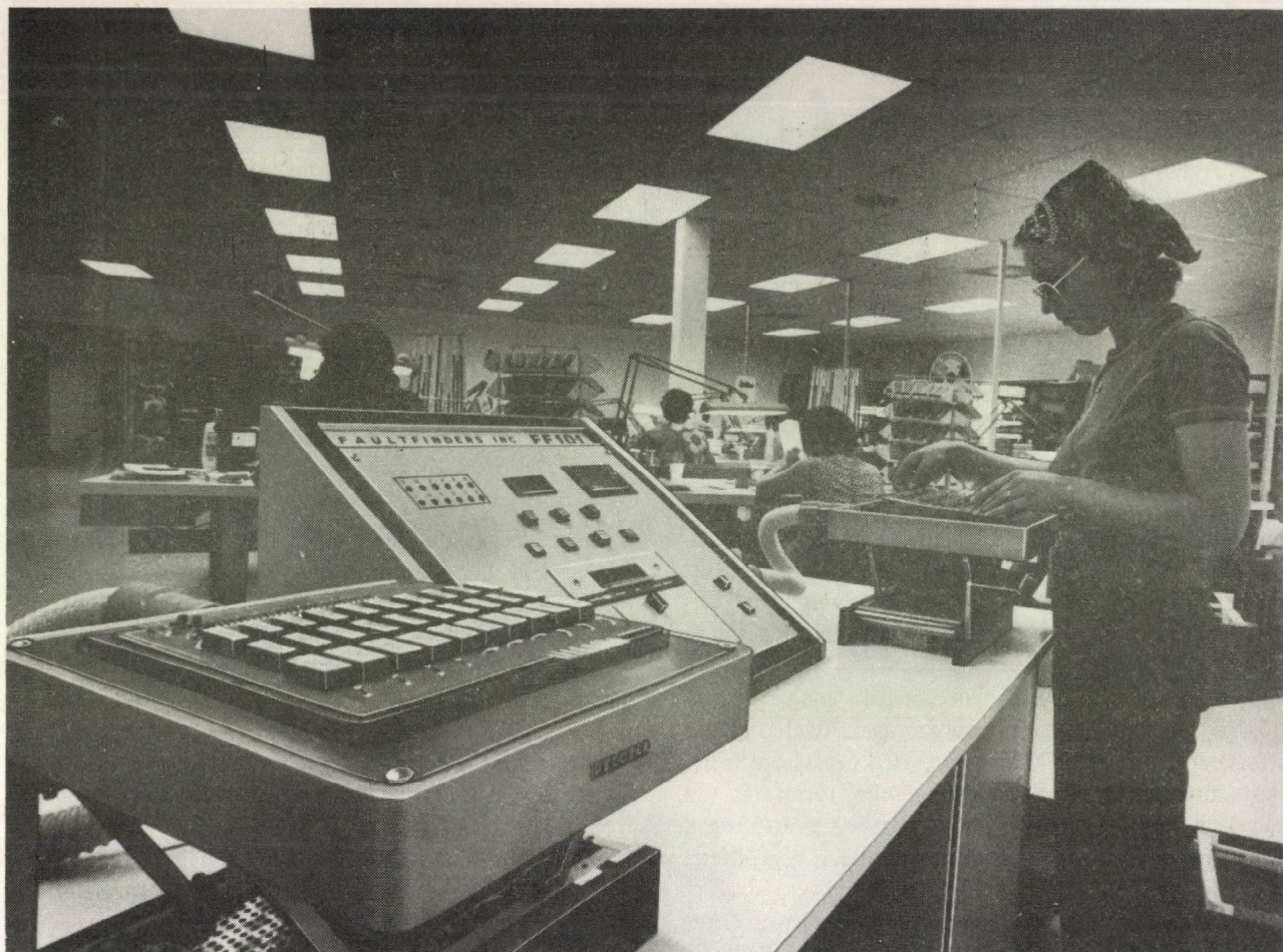
7. ábra. NYÁK-lap vizsgálat kettős vákuumos befogóval felszerelt teszteren
