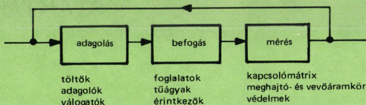
1. ábra. Csatlakozás a mérendő egységhez: műveletek és egységek
