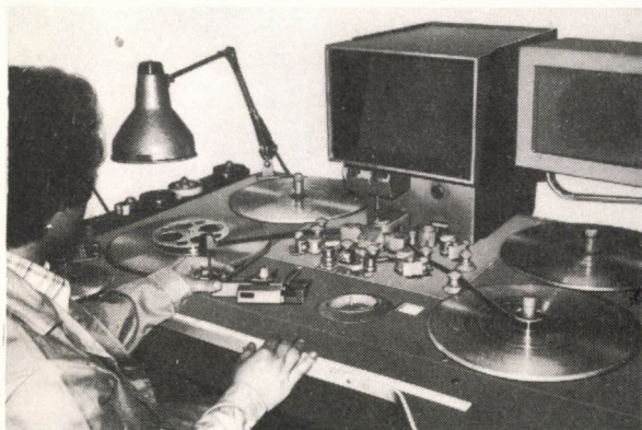
5. ábra. Vágóasztal filmfelvételek sorrendbe rakásához, vágásához. 48, 24 és 6 képkocka/s sebességgel előre-hátra menetben használható és állókép is vetíthető
