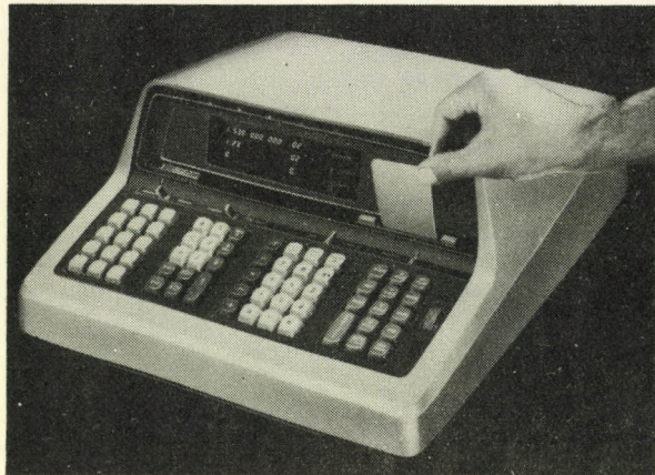
5. ábra. A program betáplálása a számítógépbe
