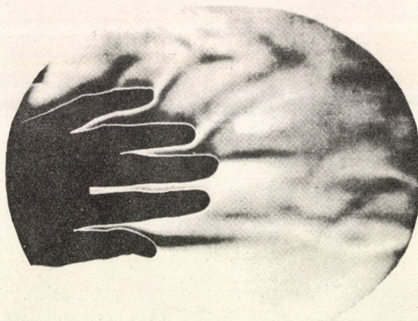
1. ábra. Szobahőmérsékletű helyiségben a schlieren-mezőbe tartott kéz körül kialakuló légáramlás
