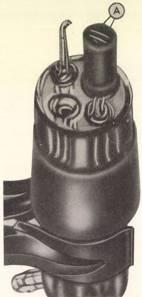
13. ábra. Kettős platinaelektrod A üvegbe forrasztott platinahuzalok
