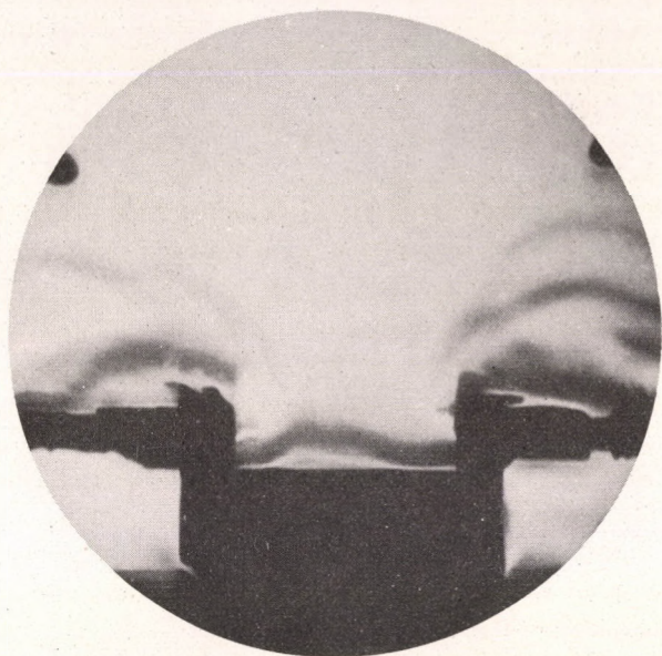
4. ábra. Schlieren-felvétel galvanizáló kád modelljéről
