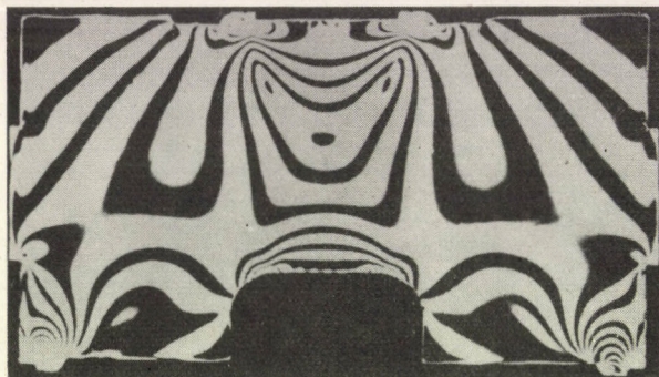
1. ábra. A képen látható tartóra erők hatnak, s a láthatóvá tett feszültség szintvonalak az igénybevétel helyét és mértékét jelzik (A. Kuske nyomán [1])
