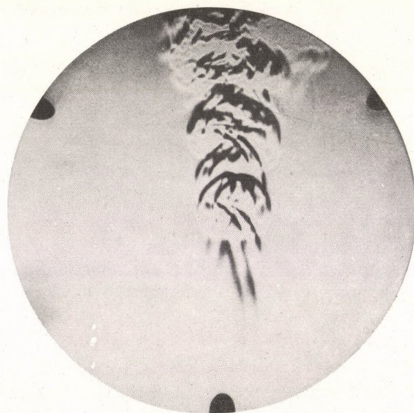
2. ábra. Schlieren-felvétel gyertya lángja felett kialakuló meleg levegő turbulenciájáról
