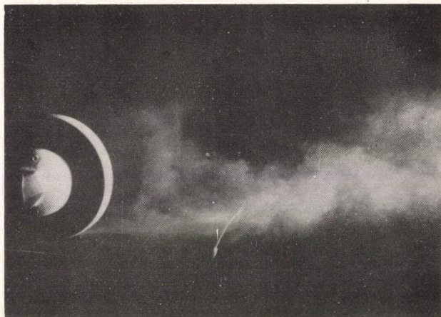
6. ábra Szabadon forgó köszörűkorong körül kialakuló lég- és poráram vizsgálata különleges fényeffektussal
