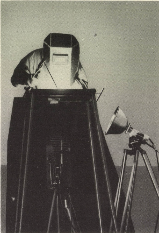
6. ábra. A filmezés felállása 16 mm-es Arriflex kamerával és impulzus fényforrással
