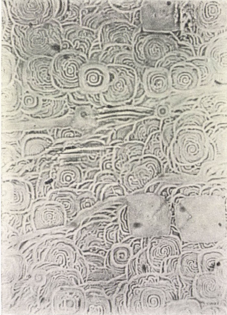
Abb. 12. Natürliches Steinsalz, Ätzdauer 40 M, 500-fache Vergrößerung
