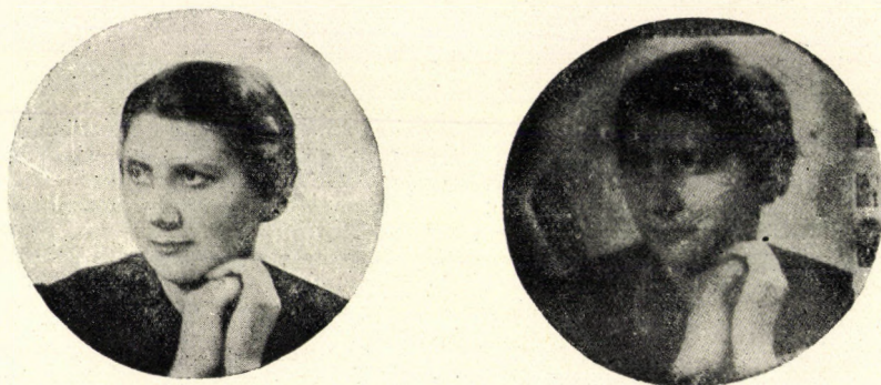
Abb. 1. Bilderzeugung auf glasigem Selen. a) die Originalphotographie, b) ihre Reproduktion auf Selen.
