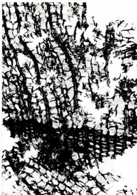
10. ábra. Merulius lacrymans bontásának harmadik fázisa. Erdeifenyő évgűrűhatár. Igen erőteljes falbontódás és szövetkiesések mind a korai, mind a késői pásztában. Keresztmetszet. Mikroszkópos felvétel: 120 \times .
