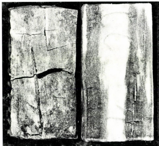
4. ábra. Pincegomba ( Coniophora cerebella ) bontásképe erdeifenyő szijács próbatesteken, 3 hónappal a gombatenyésztésre történt ráhelyezés után
