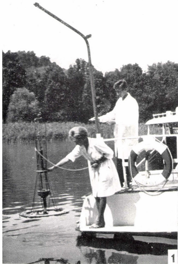
1. Módosított Craib-féle iszapvevő készülék a leengedés pillanatában. — 2. Az iszapminta kivétele
