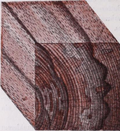
Fig. 7. Würfel aus dem Inneren eines mit Eosinwasser imprägnierten Kerholzstückes.
