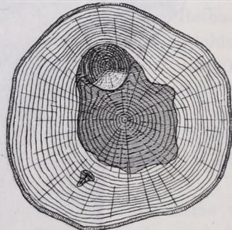
Fig. 5. Falscher Kern mit einem Faulaste. Im Splinte eine kleine überwallte Wundstelle.
