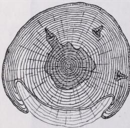
Fig. 4. Querschnitt eines Stammes mit falschem Kerne und einer, durch Sonnenbrand entstandenen faulen Stelle. Im Splinte kleine, überwallte Wundstellen.
