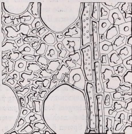
Fig. 10. Querschnitt durch weißfaules Buchenholz. 340 : 1
