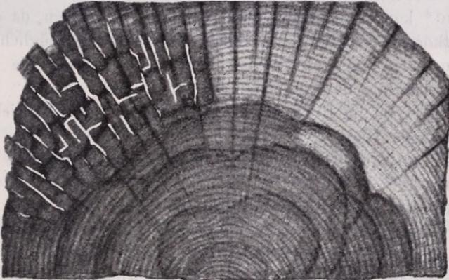
Fig. 20. Querschnitt einer durch *Poria vaporaria* (links) und *Polyporus hirsutus* (rechts) zersetzten Eisenbahnschwelle.
