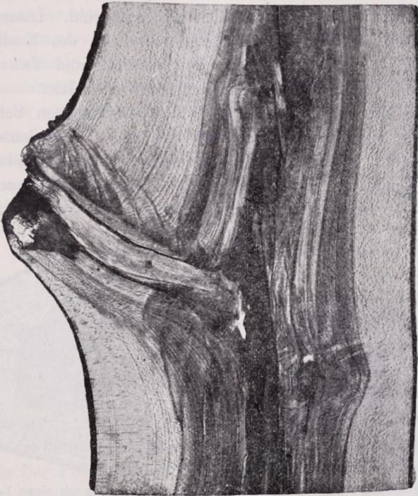
Fig. 3. Faulast, durch welchen der falsche Kern entstanden.
