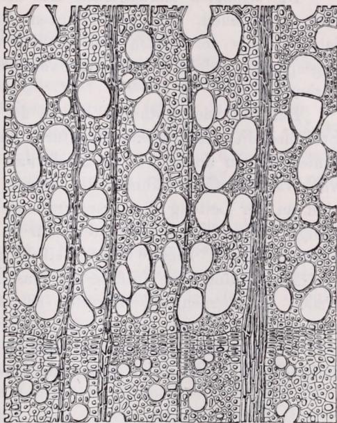
Fig. 1. Querschnitt durch das Holz des 100sten Ringes einer Rotbuche. 80 : 1.
