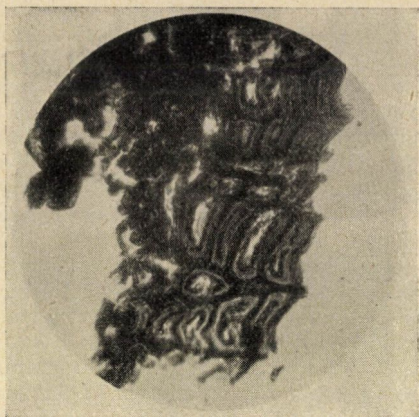
11. és 12. kép. Várpalotai szénből készült csiszolat; sejtek, baloldalt keresztmetszetben, jobboldalt hosszmetsetben.
