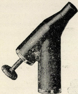
9. kép. Forrasztó páka, a Cox-féle berendezéshez.
