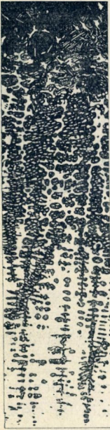
5. kép. Alumínium-nikkel ötvözet csiszolata. (Különválás.) 18-szoros nagyítás.
