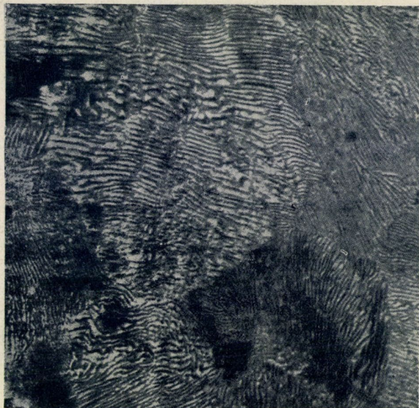
14. kép. Vas-szén eutektikum. 300-szoros nagyítás.
