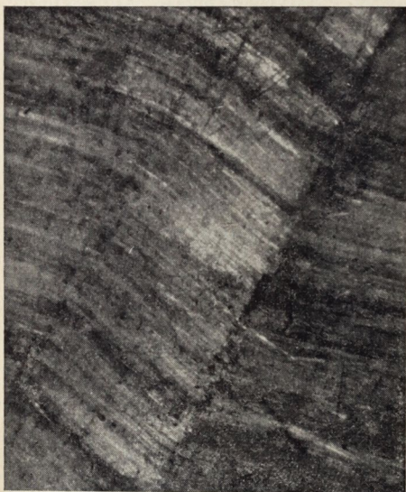
1. kép. Dobsinai szerpentin-aszbeszt. A merev szálak kisebb nyomásra egyenes vonalmentén törnek meg. Nagyítás kb. 10-szeres. (Szerző felv.)
