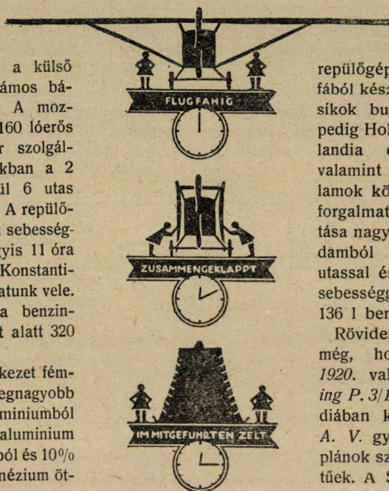
4. kép. Reklámkép, mely azt mutatja, hogy a repülőgépet 2 ember egynegyed óra alatt leszereli és szállításra képes állapotba helyezi.
