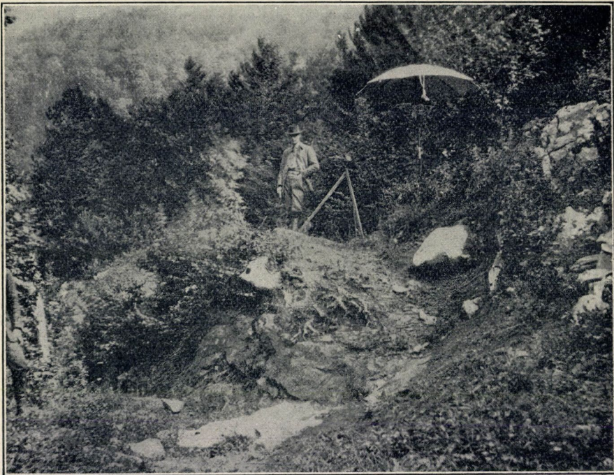
4. kép. A geológus magnetométerrel kutatja a vasércztelep vonulását. PÁLFY MÓR fotografiai fölvétele.
