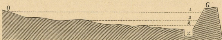
3. ábra. A fokozatos vízdagasztás. G a gát; x az árok; 3 első dagasztás, 2 második dagasztás, 1 harmadik dagasztás.
