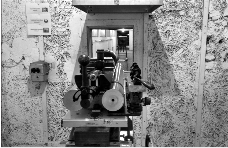
1. ábra. Ballisztikai mérőcső csőbefogó állománya a löfolyósóban (Forrás: saját felvétel)
