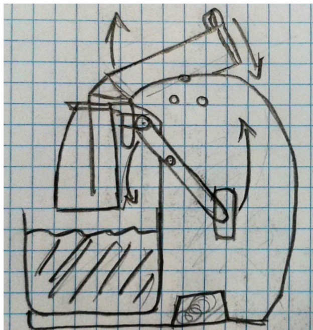
9. ábra. Bulyáki Ádám gimnáziumi tanuló ötletének vázlatrajza a tea gyorshűtésére és utána állandó hőmérsékleten tartására.
