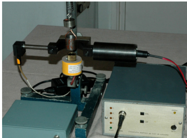
9. ábra. A megfógó elektromágnes és a fénysorompó. A sárgaréz anya biztosítja az állandó nehezék és az elektromágnes közvetlen érintkezésének a megszüntetését, a remanencia hatásának lényeges csökkentését.
