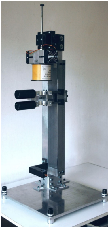
10. ábra. Mini-szabadesés készülék. Az oszlop alá szerelt L formájú tartóba kerül az elektromágnes. A rugó megnyúlását század mm-es pontossággal lehet megmérni.
